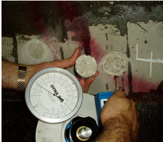
Bild 8: Prüfung der Haftzugfestigkeit
