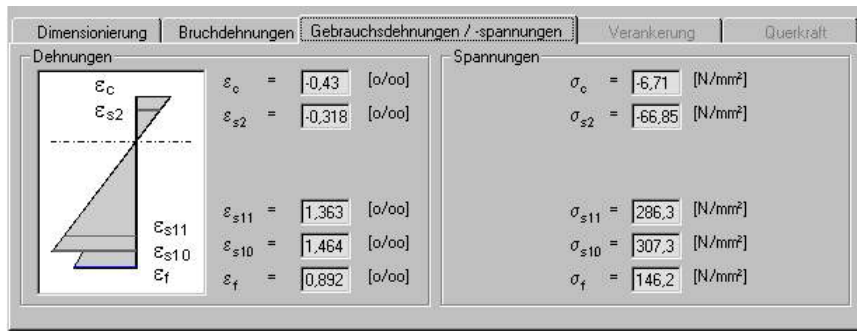
Bild 12 Ergebnismaske Dehnungen und Spannungen im Gebrauchszustand
